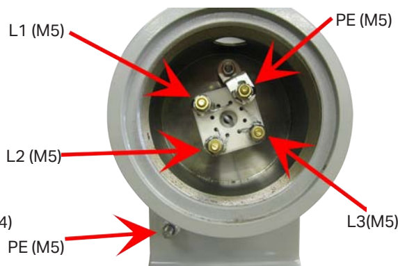
Fig. 6 Elektrischer Anschluss für ERB 3 ph
