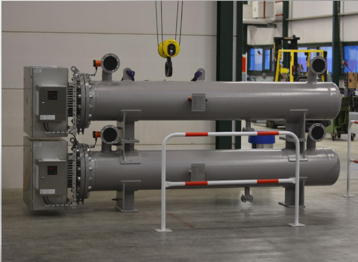
Нагрузочные резисторы на водяном охлаждении 1.8 МВт каждый
